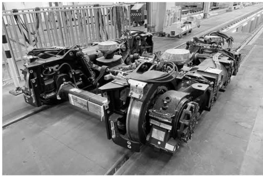
Bild eines Drehgestells, dem Laufwerk von Schienenfahrzeugen. Die beiden Radsätze sind in einem um die Vertikalachse drehbaren Rahmen gelagert. Bei modernen Ausführungen mit tiefliegender Bodenkonstruktion, sprich Niederflurtechnik, sind die Antriebe auf der Seite angebracht.
